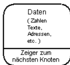
Abbildung 1.1: Aufbau eines Knotens (Node)
