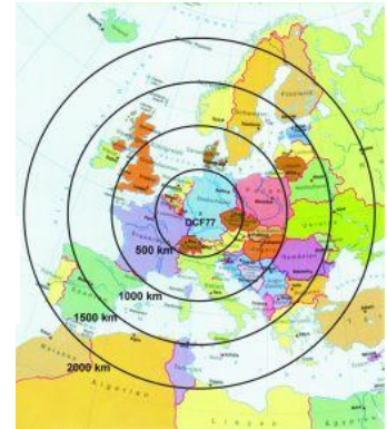
Bild 2.1: Reichweite des DCF77-Senders (Quelle: www.dcf77.com/)
